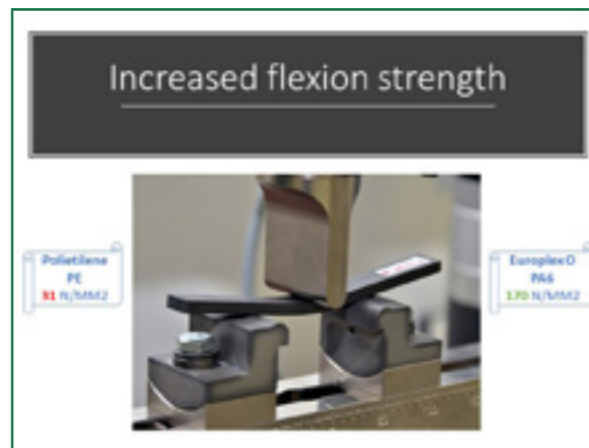
Fig. 12.1 Poliammide 5 volte più resistente del polietilene
