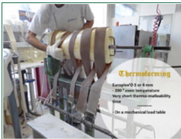
Fig. 12.15 Termoformatura come corsetto Stagnara
